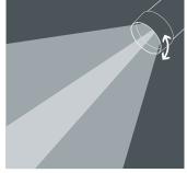
Zoomstrahler Durch ein einfaches Drehen der Linse lässt sich der Lichtkegeldurchmesser stufenlos von spot (15°) bis wide flood (65°) justieren. Zoomstrahler eignen sich insbesondere zur Beleuchtung von Bereichen mit wechselnden Exponaten und Waren.
